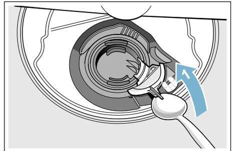
6. Flügelrad auf Fremdkörper prüfen und diese gegebenenfalls entfernen.
