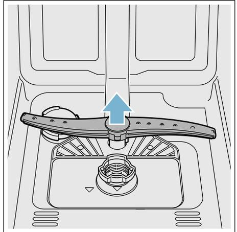
4. Sprüharme unter fließendem Wasser reinigen.
