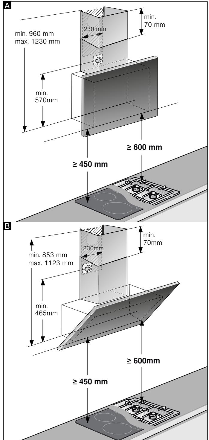
**Hinweis:** Wir empfehlen das Gerät so aufzuhängen, dass die untere Kante des Glasschirms mit der Unterkante der benachbarten Oberschränke eine Linie bildet. Sicherstellen, dass die angegebenen Sicherheitsabstände zum Kochfeld eingehalten werden.
