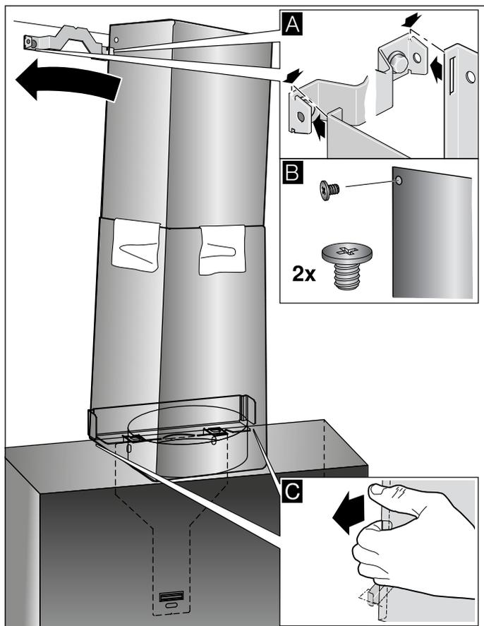
7. Untere Kaminverblendung am Haltewinkel einklippen. Das Anschlusskabel darf nicht beschädigt werden! **C**
